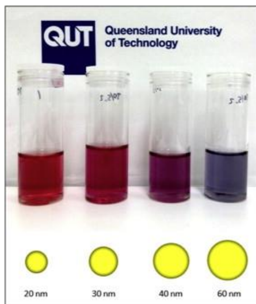
Rys. 2. Barwa roztworu nanocząstek złota w zależności od średnicy nanoobjektów 2 .
